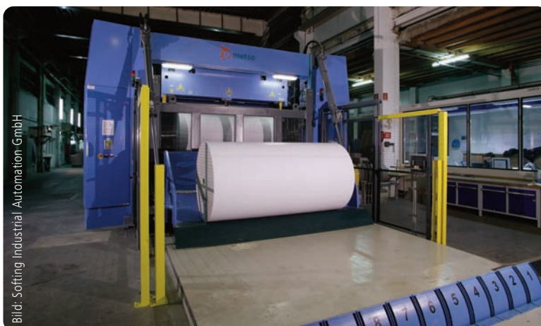
Bild 2: Die Rollenschneidmaschine schneidet und rollt die produzierten Testliner kundenspezifisch in verschiedenen Breiten und Lauflängen um.
