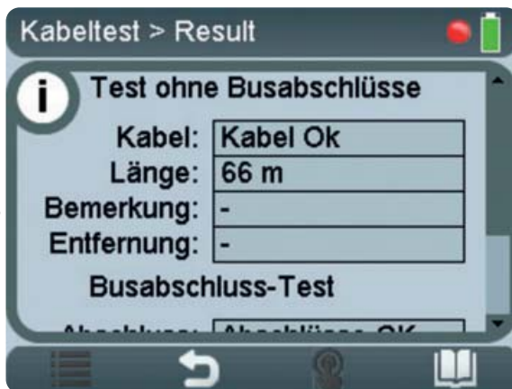
Bild 2: Ergebnisse des Profibus-Kabeltests
