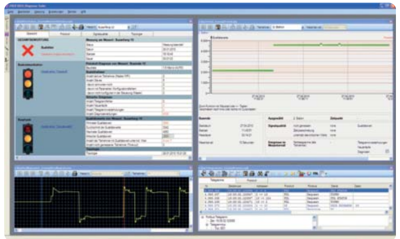
Bild 3: Ergebnisse der logischen Analyse eines (fehlerhaften) Profibus-Netzes
