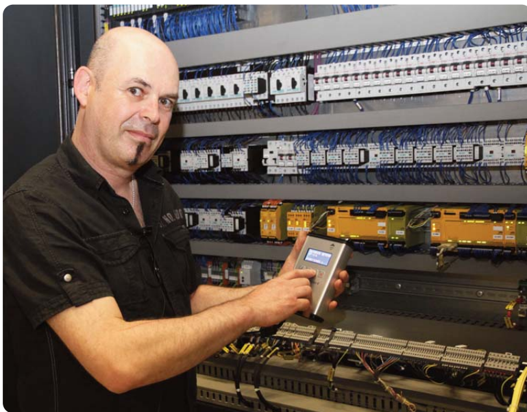
Bild 2: Im Profibus-Tester 4 sind vier Messgeräte in einem handlichen Gerät vereint: ein Signaltester, ein Speicheroszilloskop, ein Protokollanalysator und ein Mastersimulator.
